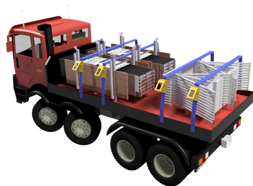
Beim Transport Steckböcke und Gerüstbeläge mit Spanngurt sichern
