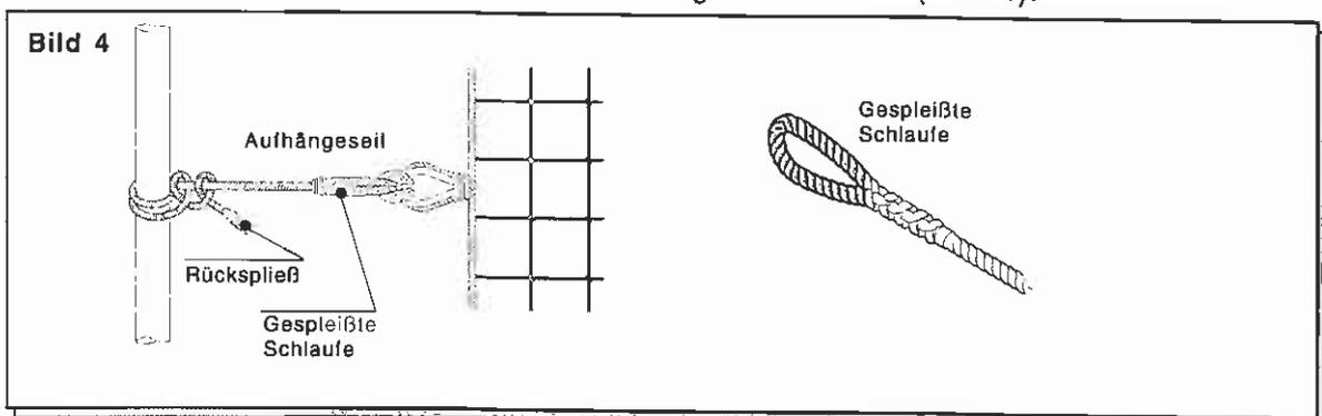
Netzaufhängung mittels **Halteseil 8 mm** und evtl. **Sicherheits-Karabinerhaken** im Abstand von mindestens 2,50 m (Bild 5).
